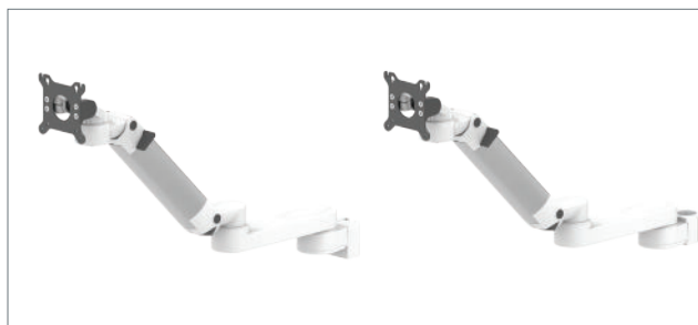
Braccio ad altezza regolabile offset 450 mm, movimento verticale 438 mm con estensione di 230 mm per monitor VESA (16 kg max)
