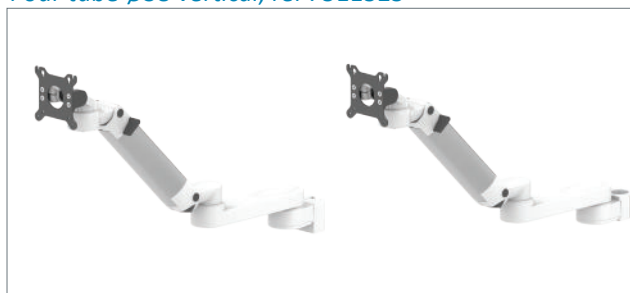
Bras ajustable en hauteur déport de 450 mm, débattement vertical 438 mm avec allonge de 230 mm pour écran VESA (max 16 kg)
