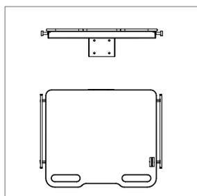
**Plateau 605x455 mm avec rails latéraux avec poignées (60 kg max)**
