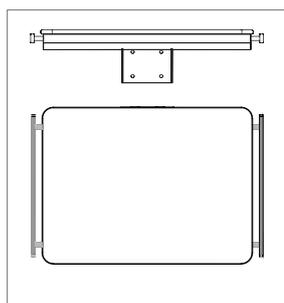
**Plateau 605x455 mm avec rail latéraux sans fixation (60 kg max)**
