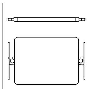
**Plateau 605x455 mm avec rail latéraux (60 kg max)**
