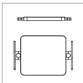
**Plateau 405x355 mm avec rails latéraux (40 kg max)**
