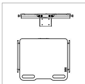
**Plateau 605x455 mm avec rails latéraux avec poignées avec commandes (60 kg max)**
