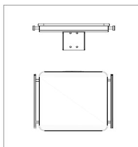
**Plateau 405x355 mm avec rail latéraux sans fixation (40 kg max)**
